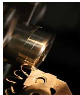
プラチナの棒材からリングを削り出す 切削工程
